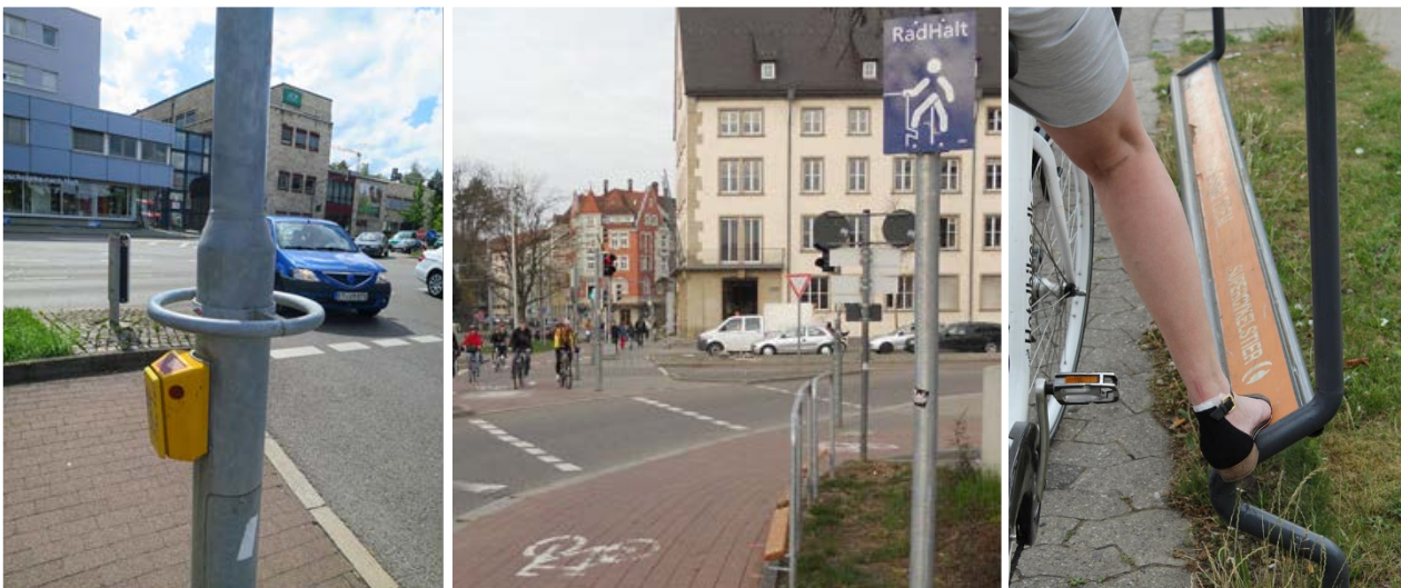
Abb. 76: Haltegriff Stadt Reutlingen (links); RadHalt Stadt Ulm (Mitte), Trittbrett Stadt Kopenhagen (rechts)
