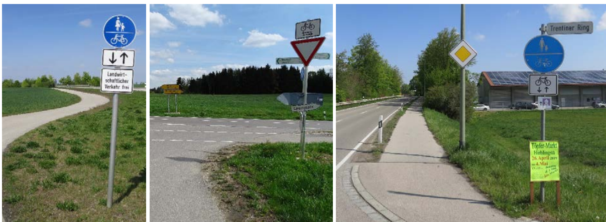
Abb. 46: Zusatzzeichen zur Kennzeichnung von Zweirichtungsradwegen v.l.n.r.: 1000-31 (empfohlen), 1000-32 (empfohlen, an Kreuzungen über vorfahrtsregelnden Zeichen verpflichtend); 1000-33 (nicht mehr gültig)
